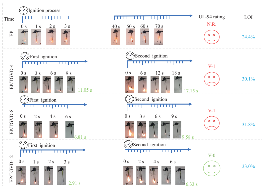
图5 EP和EP/TGVD的垂直燃烧测试过程及LOI测试结果
